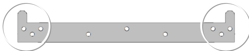
Рис. 15 Монтажная планка (кронштейн крепления котла на стене)
